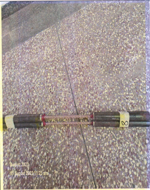
Description: ÉCHANTILLONS DE BARRES D'ARMATURE DE 8 MM; AVANT TEST
