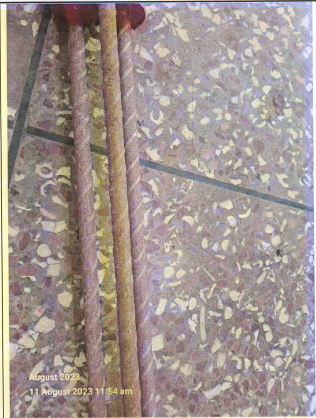
ÉCHANTILLONS DE BARRES D'ARMATURE DE 10 MM; AVANT TEST
