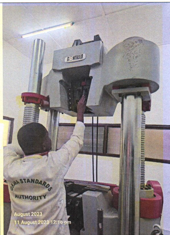
OPÉRATEUR CHANGEANT LES MÂCHOIRES DE LA MACHINE EN FONCTION DE LA TAILLE ;10MM
