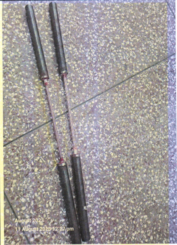
ÉCHANTILLONS DE BARRES D'ARMATURE DE 10 MM; APRÈS LE TEST
