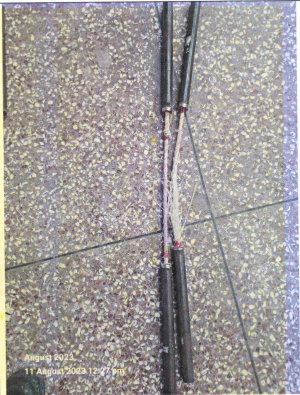
Description: ÉCHANTILLONS DE BARRES D'ARMATURE DE 8 MM; APRÈS LE TEST
